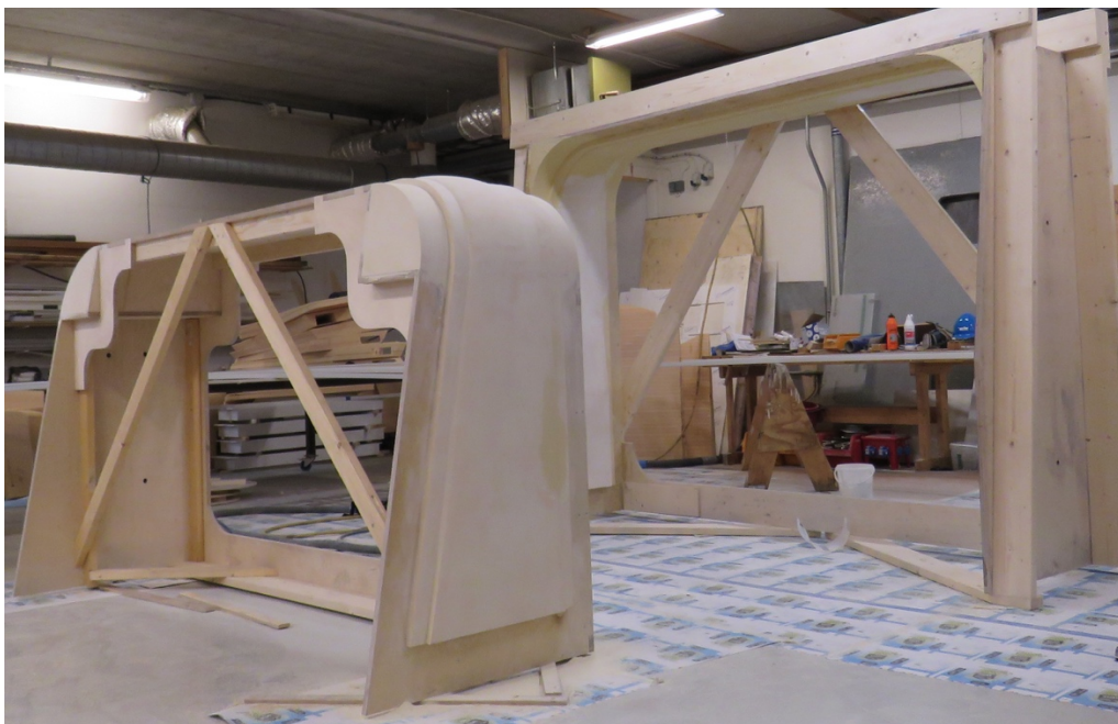
Figur 87: 6. Februar 2019 - Formene til hovedvingen er klare
