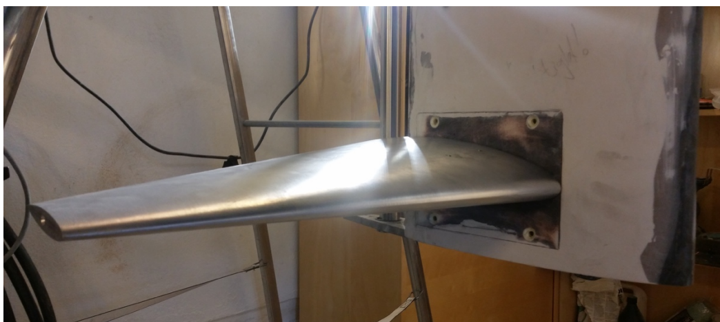
Figur 94: 21. Mars 2019 - Montering av styreflater på hale
