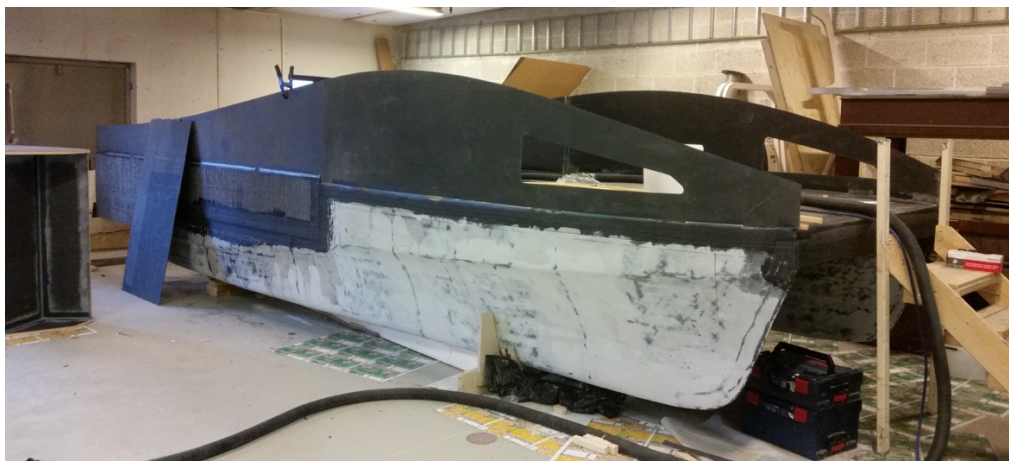
Figur 89: 1. Mars 2019 - Sidekanter til skroget blir montert
