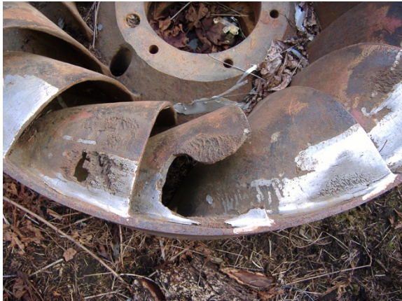
Figur 29: Kavitasjonserosjon på en Francis turbin
