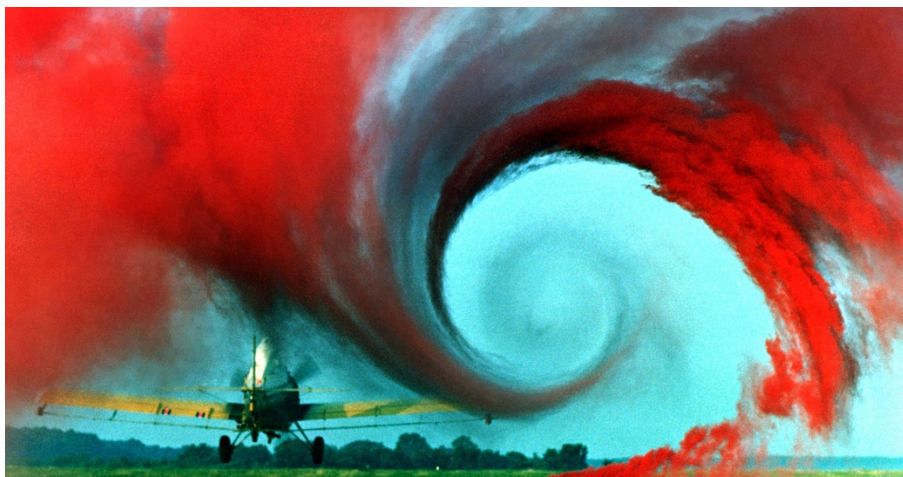
Figur 15: Bilde som viser resultatet av løft-indusert motstand. Virvler fra tuppen av vingen vises ved hjelp av røyk bak et fly. Kilde: Wikipedia [9]
