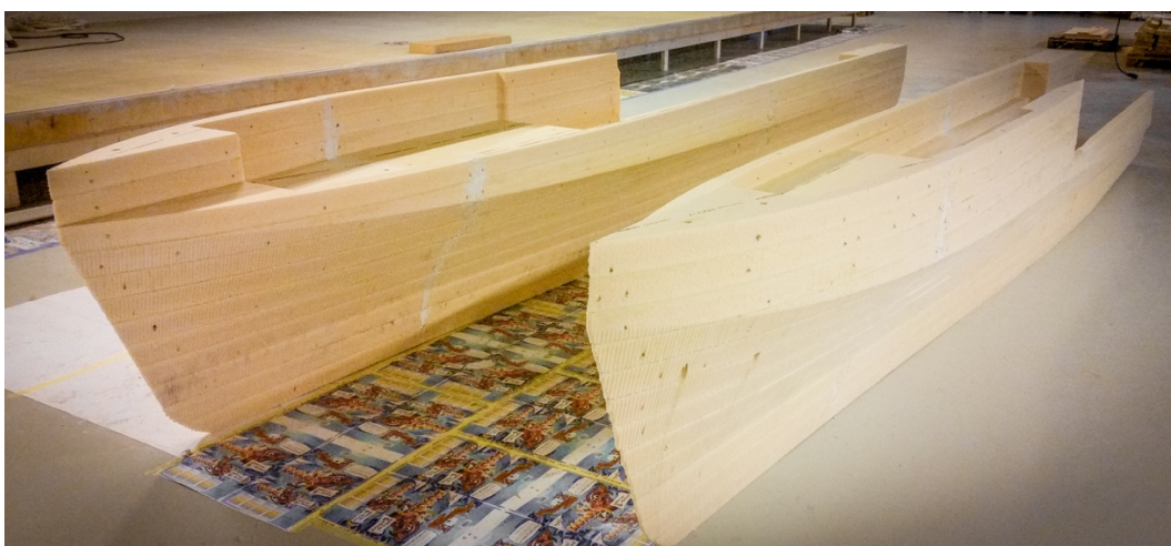
Figur 84: 2. November 2018 - formene til skroget er ferdig frest
