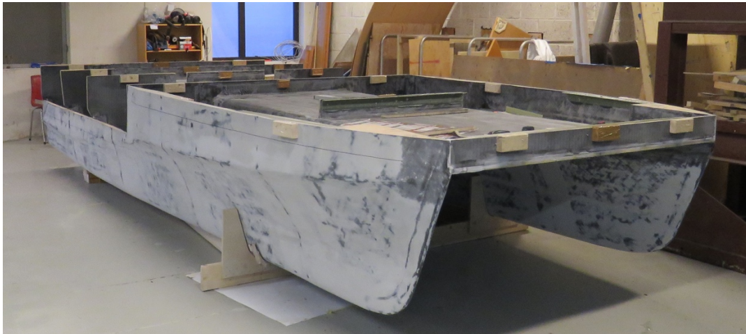
Figur 86: 6. Februar 2019 - Skroget er ferdig kledd med karbonfiber
