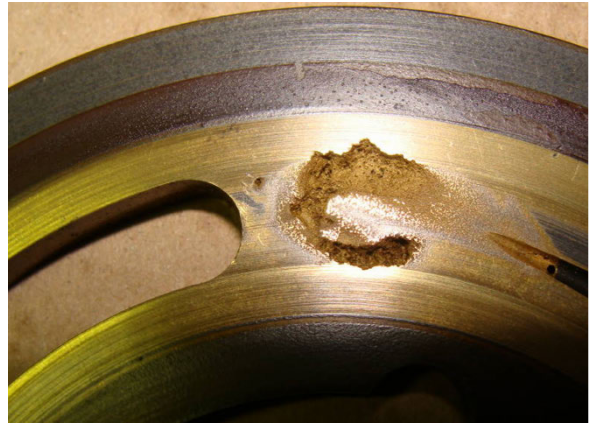
Figur 30: Kavitasjonserosjon på en hydraulisk pumpe
