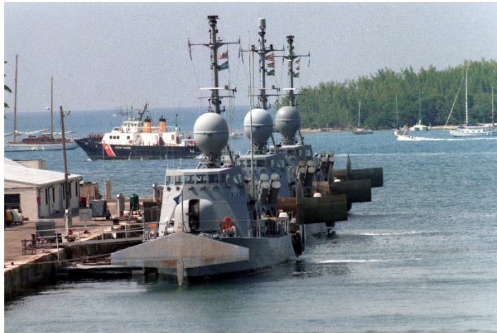
Figur 54: Pegasus-hydrofoiler med oppsvingede hydrofoilsystemer
