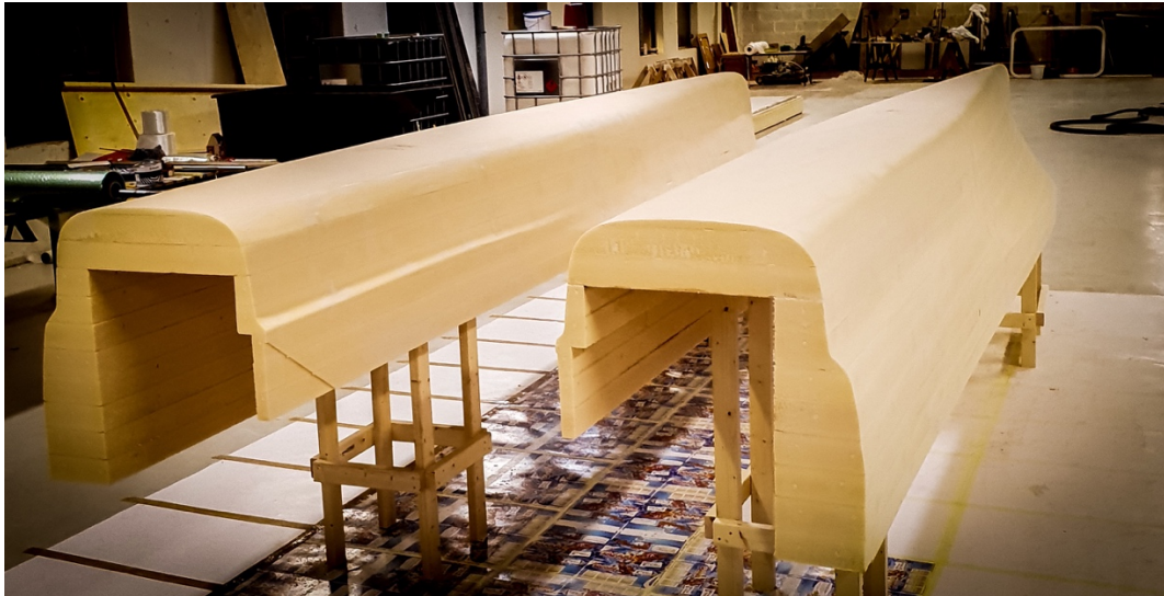
Figur 85: 7. November 2018 - skrogene er klare for å bli kledd med karbonfiber
