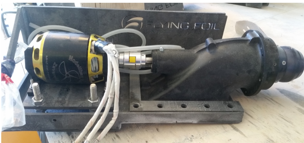
Figur 99: 16. Mai 2019 - Montering av vanjet
