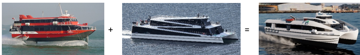
Figur 81: Flyer 20 og Flyer 30 er kombinasjonen av to kjente teknologier: hydrofoiler og batterier.
