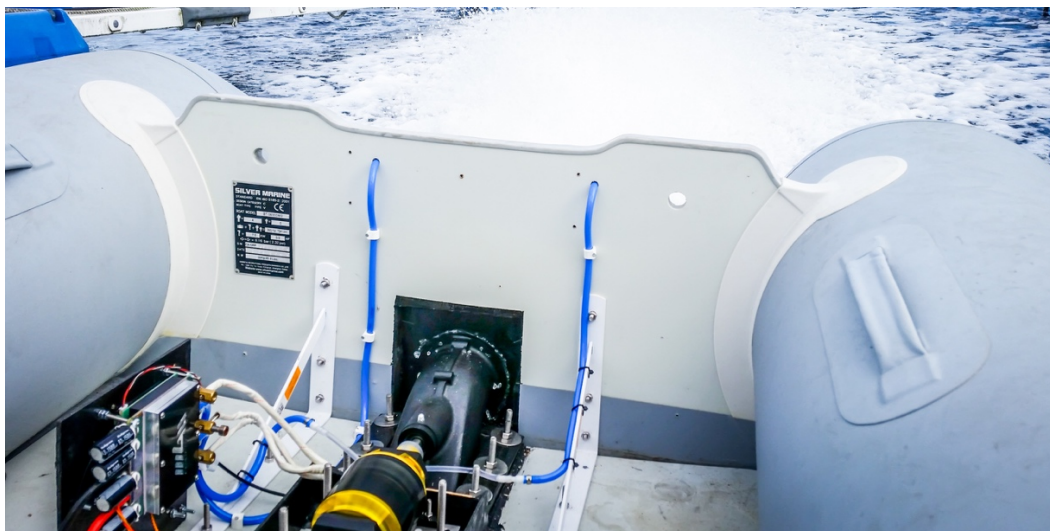
Figur 83: 19. September 2018 - Testing av vannjetten til prototypen ved hjelp av en gummibåt
