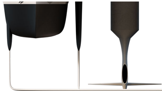
Figur 17: Kombinert winglet og støtte på Flyer 30
