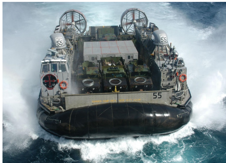
Figur 51: US Navy Landing Craft Air Cushion (LCAC) med luftpropulsjon. I dette tilfellet to store vifter akterut, drevet av hver sin gassturbinmotor.
