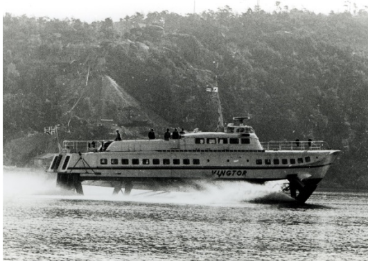
Figur 47: MS Vingtor, med skråstilte propellaksler så vidt synlig under aktre del av skroget. Foto: Stavanger Maritime Museum
